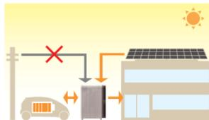
太陽が照っていれば、停電中でもPVからEVへの再充電が可能なので、停電の場合でも安心です。
