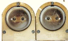
ソケットが熱劣化により変色しています。
